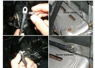
INSTALACIÓN DEL SENSOR DE TEMPERATURA EN EL MOTOR
